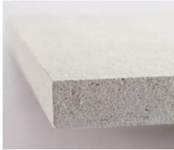
Gyps Fiber è un materiale costituito da una miscela omogenea di gesso di alta qualità e fibra di cellulosa. L'impasto viene addizionato con acqua e compresso ad alta pressione, in modo da formare lastre resistenti e monolitiche.
