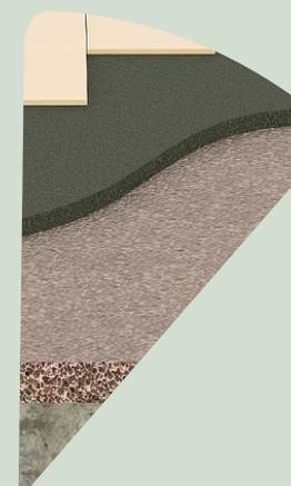
Sottostrato di agglomerato di sughero per l'isolamento acustico del rumore da calpestio e l'isolamento termico nei pavimenti. Viene installato direttamente sotto il pavimento creando il massimo comfort della camminata con spessore ridotto. Massima durabilità e resilienza a lungo termine con un prodotto naturale e sostenibile al 100%.
